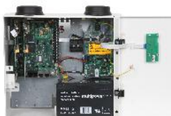
IP Basisbaugruppe TLV 1 imGehäuse G4+ mit Netzteil
