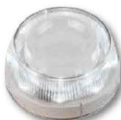
Die Sirene WSST IS ist eine adressierbare Wandsirene /-Blitzleuchte mit eingebautem Trennmodul, geeignet für den Einbau in adressierbaren Brandmeldeanlagen mit dem TTE-Kommunikationsprotokoll.
