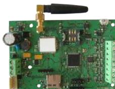
TTE GPRS Standard ist ein universelles Kommunikationsmodul. Das Modul wird verwendet, um Alarmsmeldungen an die Leitstelle oder den Endverbraucher zu senden. TTE GPRS Standard kann auch für die Fernverwaltung, Programmierung und Überwachung des Sicherheitssystems zusammen verwendet werden.
