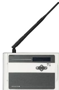
Das Funk-Gateway ist zur Integration von Funk-Komponenten der Serie NATRON in die Brandwarnanlagen IRIS4 und IRIS8 (WE-A) oder an eine Brandmeldeanlage (WE-C). Das Gateway wird über die Ringbusleitung überwacht und mit Spannung versorgt. Bis zu 54 Funk Komponenten können mit dem Gateway vernetzt werden.
