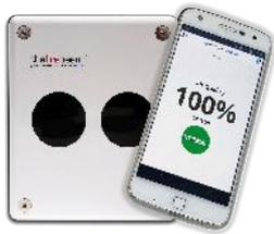
Der Firebeam ist ein Lichtschrankenrauchmelder mit Prismen-Reflektoren zur Detektion von hellem und dunklem Rauch, über eine Strecke von 7 bis 160 m, bei einer seitlichen Detektionsbreite von 7 m beiderseits der Strahlmittelachse. Bedienung über Bluetooth Applikation
