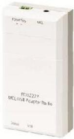
Der MCL-USB Adapter (Funk) ist ein Schnittstellenkonverter für USB auf MC-Link. Mit ihm lassen sich FDnet/C-NET-Geräte über ein serielles Protokoll (MC-Link) mit dem PC verbinden. Der Adapter wird für das Firmware-Update oder im laufenden Betrieb verwendet.
