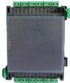
Funktionsmodul mit acht unabhängigen digitalen Eingängen und 8 Open-Collector Ausgängen.
