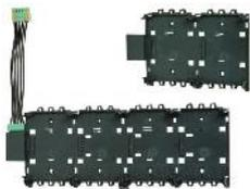
Der kurze und der lange Modulträger sind Plug-and Play-Rails aus glasfaserverstärktem Kunststoff für zwei bzw. vier Module. Über die Steckkontakte im Rail wird, sowohl die Stromversorgung der Module als auch der gesamte Datenverkehr zwischen Modul und Zentrale realisiert.
