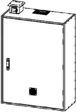
Geprüftes Brandschutzgehäuse mit einer Feuerwiderstandsdauer von mindestens 30 Minuten, bei einer Brandbelastung von außen und innen im Sinne F30 geprüft, in Anlehnung an DIN 4102-2 und DIN EN 1363-1 im Sinne EI30 (i <-> o), sowie DIN EN 1634-3.
