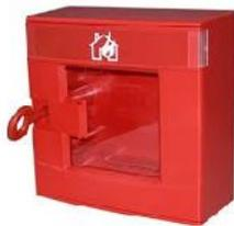
Mit dem Funk-Handfeuermelder wird im Brandfall oder einem anderen Notfall ein Alarm ausgelöst. Der Melder besteht aus einem Gehäuse und einer Schalteinrichtung, einschließlich Funkelektronik und Dual-Band-Antenne.
