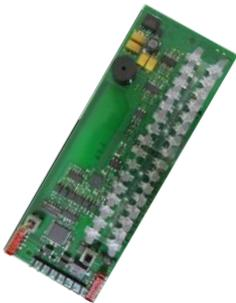
Der Bausatz ATG 420 LSNi ist eine Platine mit 32 mehrfarbigen LED (rot/gelb) und wird in das Gehäuse BAT 100 LSN eingebaut. Bis zu 3 Bausätze ATG 420 LSNi sind im Gehäuse BAT 100 LSNi installierbar.
