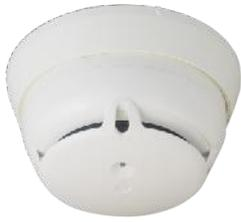
Der batteriebetriebene Funk-Brandmelder verfügt über eine hochwertige opto-elektronische Messkammer mit zwei optischen Sendern, einen optischen Empfänger und zwei Temperatursensoren.
