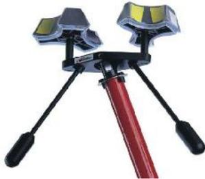
Der Universal-Meldertauscher ist durch die drehbaren Greifsegmente mit drei verschiedenen Durchmessern für das Einsetzen und Entfernen der meisten Brandmelder geeignet. Im Lieferumfang befinden sich zwei Plastikkappen, diese dienen zum sicheren Greifen der Brandmelder und schützen damit gleichzeitig die Melderoberfläche vor Beschädigung.
