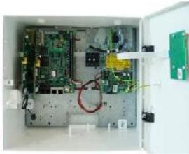
IP-Basisbaugruppe TLV 1 im Gehäuse G4+ (mit 4 LED) mit Netzgerät NT 560/12E inkl. LTE-Wegemodul TEL 1 und 1 **Brandmeldeadapter XBT1** (ohne Antenne)
