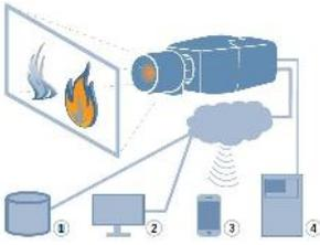
Die videobasierte Branderkennung ist ideal für Umgebungen geeignet, in denen zuverlässige Bewegungs- und Branderkennung per Video erforderlich ist. Sie funktioniert im Alleinbetrieb und benötigt keine separate Auswertungseinheit.
