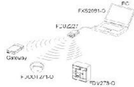
» Abrufen von Diagnosedaten einer einzelnen Funkzelle, Adapter wird direkt mit dem Funk-Gateway verbunden
