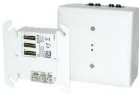
Durch das EOL-Modul werden Gleichstromlinien für die Überwachung auf schleichende Unterbrechung abgeschlossen (ELS, früher EN 54-13-Anforderung). Es erkennt Störungen der Primär- und AUX-Leitungen und meldet diese an die Brandmeldezentrale.
