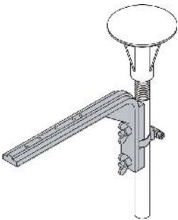
Der Montagewinkel ist eine Befestigungsvorrichtung für die Meldersockel der Brandmelder der Serien 425 und 320 zur Montage in Zwischenböden, z.B. in Doppelböden von EDV-Räumen.
