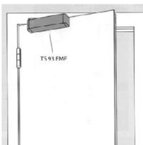
Im Alarmfall oder bei Stromausfall wird die elektromechanische Feststellung aufgehoben und die Tür schließt sich.
