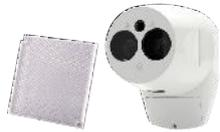
Der FRAY-ONE ist ein einfach zu montierender und kostengünstiger linearer Rauchmelder. Er deckt Entfernungen zwischen 5 m und 120 m ab. Ein reflektierendes Prisma ermöglicht die genaue Erkennung von Rauchpartikeln innerhalb der angegebenen Entfernungreichweite. Für Reichweiten zwischen 5 m und 50 m ist ein Prisma ausreichend. Für Reichweiten zwischen 50 m und 120 m sind vier Prismen erforderlich.
