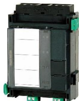
Funktionsmodul mit zwei Wechselkontakt-Relais zur überwachten Anschaltung von externen Elementen mit Rückmeldung (z. B. Türhaftmagnete, Lüfter, Rauchklappen). Das Modul kann auch als Löschanlagen-Schnittstelle gemäß VdS 2496 eingesetzt werden.
