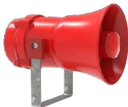
Der Ex-akustische Signalgeber BEXS110D-24 DC kann über den Koppler FLM-420-NAC-D an die FSO-Brandmeldeanlage angeschlossen werden. Dieses Gerät ist nicht adressierbar. Der Signalgeber verfügt über eine Produktzertifizierung nach DIN EN 54-3.
