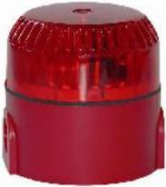
Die Blitzleuchten der Serie 320 sind universell einsetzbare Signalgeber für die optische Alarmierung zur Anschließung an Brandmelder- oder Hausalarmzentralen. Im transparenten Signalgeber-Oberteil befindet sich die Blitzröhre. Diese sendet bei Ansteuerung durch die Zentrale, entsprechend der Farbe des Signalgebers, im Sekundentakt rote, weiße, gelbe oder grüne Lichtblitze aus.
