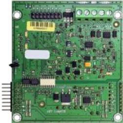
Die IRIS4/8 Loop TTE ist eine Ring-Erweiterungskarte für die Zentralen IRIS4 und IRIS8 zur An-schal-tung von drahtgebundenen Komponenten.
