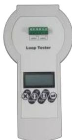
Der Loop-Tester ist ein Gerät zur Diagnose eines Ring-Netzwerkes aus vernetzten Geräten der Serie SensolRIS. Mit dem Loop-Tester können auch eigenständige Tests des Brandmeldekabels, der Funktionsfähigkeit des Ring-Netzwerkes, sowie der im Ring-Netzwerk angeschlossenen adressierbaren Geräte durchgeführt werden.
