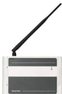
Der Funk-Signalverstärker dient zur drahtlosen Reichweitenverlängerung des Funk-Gateway Natron WE zu den Funk-Komponenten.
