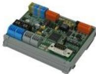
Zum redundanten Anschalten eines FATs als Feuerwehr-Erstinformation. Aus nur einer Kommunikationsschnittstelle der BMZ werden, zwei bidirektionale Übertragungswege zum FAT, zur Verfügung gestellt.
