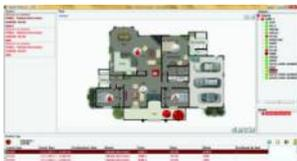
Observer ist eine Softwareanwendung zur Überwachung von Standorten, die mit Teletek adressierbaren Brandmeldeanlagen IRIS ausgestattet sind. Die Software überwacht den Zustand der Melder und Anlagen. Es ermöglicht auch die Steuerung der Brandwarnanlage IRIS. Über ein VPN-Netzwerk können Sie bis zu 32 Brandwarnanlagen mit einer Observer-Software verwalten. Observer ermöglicht den direkten Import von Dateien aus der ProsTE-Programmiersoftware.
