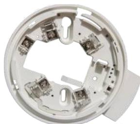
SensolIRIS B124 HP ist ein Standardsockel für adressierbare Melder und Sirenen SensolIRIS. Der Sockel hat ein höheres Profil, was die Aufputzmontage des Kabels ermöglicht. Zusätzlich verfügt der Sockel über eine Kunststoffplatte zur Gerätebeschriftung und bietet ein Kontaktsystem zur direkten Befestigung des Melders. Für zusätzliche Sicherheit ist es möglich, den Melder am Sockel zu verriegeln.
