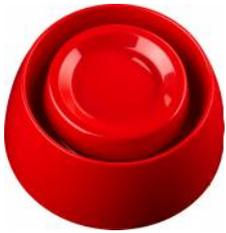
Die Sirene WSOU IS ist eine adressierbare Wandsirene mit eingebautem Trennmodul, geeignet für den Einbau in adressierbare Brandmeldeanlagen mit dem TTE-Kommunikationsprotokoll. Die Sirene wird von der Zentrale aus adressiert und kann über das Kommunikationsprotokoll gesteuert werden. Die Sirene WSOU IS wird auf dem Sockel B124 HP oder WSB IP65 montiert. Der Sockel ist **nicht** im Lieferumfang enthalten.
