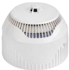
Funk-Multimelder (optisch/thermisch) mit Zulassung EN54-5, EN54-7 wie auch nach EN 54-25 (Funk). Der batteriebetriebene Funk-Melder ist geeignet für den Einbau in die adressierbare Brandmeldeanlagen IRIS4 mit dem Funk-Gateway Natron WE-A oder an eine konventionelle Brandmeldezentrale mit dem Funk-Gateway WE-C.
