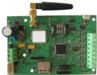
TTE GPRS Standard ist ein universelles Kommunikationsmodul im Gehäuse. Das Modul wird verwendet, um Alarmmeldungen an die Leitstelle oder den Endverbraucher zu senden. TTE GPRS Standard kann auch für die Fernverwaltung, Programmierung und Überwachung des Sicherheitssystems zusammen verwendet werden.
