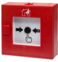
SensoIRIS MCP150 ist ein adressierbarer Druckknopfmelder mit eingebautem Isolator, geeignet für den Einbau in adressierbare Brandmeldeanlagen mit TTE-Kommunikationsprotokoll. Der Druckknopfmelder wird von der Zentrale aus adressiert und kann über das Kommunikationsprotokoll gesteuert werden.
