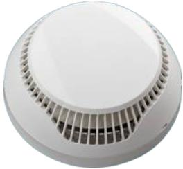
SensolRIS T110 IS ist ein adressierbarer Temperaturmelder mit eingebautem Isolator, geeignet für den Einbau in adressierbare Brandmeldeanlagen mit dem TTE-Kommunikationsprotokoll. Der Melder wird von der Zentrale aus adressiert und kann über das Kommunikationsprotokoll gesteuert werden. Der Meldersockel ist **nicht** im Lieferumfang enthalten.
