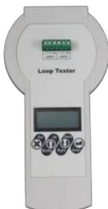
Der Loop-Tester ist ein Gerät zur Diagnose eines Ring-Netzwerkes aus vernetzten Geräten der Serie SensorIS. Mit dem Loop-Tester können auch eigenständige Tests des Brandmeldekabels, der Funktionsfähigkeit des Ring-Netzwerkes sowie der im Ring-Netzwerk angeschlossenen adressierbaren Geräte durchgeführt werden.
