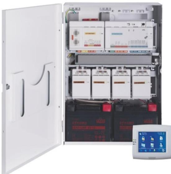
Die MAP 5000 unterstützt **bis zu acht LSNi-Module**. In das Zentralengehäuse können bis zu vier auf dem Schwenkrahmen montiert werden. Zusätzliche vier LSNi-Module können in den optionalen Erweiterungsgehäusen montiert und an den internen CAN-Bus angeschlossen werden. Jedes LSNi-Modul unterstützt eine Ring- oder zwei Stichkonfigurationen.
