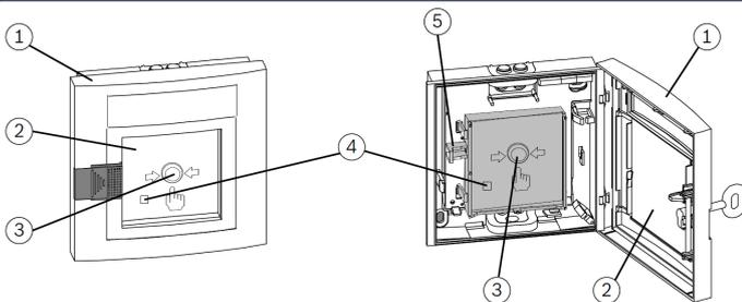
Im Alarmfall wird zuerst die Glasscheibe (2) eingeschlagen, dann wird der Druckknopf (3) tief eingedrückt. Dabei wird der Mikroschalter zur Alarmauslösung betätigt und die Anzeige-LED (4) blinkt. Ein Mechanismus lässt den Druckknopf einrasten.
