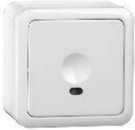
An der Eingabeeinheit EE wird mit Hilfe des elektronischen SmartKey-Schlüssels scharf- bzw. unscharf geschaltet. Zwei LED und ein Summer informieren dabei über den Zustand des Systems sowie der Bedienung. Die Eingabeeinheit kann sowohl auf Putz als auch unter Putz montiert werden (außerhalb des gesicherten Bereiches).
