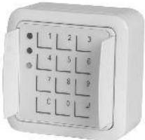
An der Codetastatur mit integrierter Eingabeeinheit TEE wird mit Hilfe des elektronischen SmartKey-Schlüssels und einer Zahlenkombination scharf- bzw. unscharf geschaltet. Drei LED und ein Summer informieren dabei über den Zustand des Systems sowie der Bedienung. Die Eingabeeinheit kann sowohl auf Putz als auch unter Putz montiert werden (außerhalb des gesicherten Bereiches).
