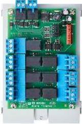
Das ICP-COM-IF Relaismodul ist primär für die Anschaltung von externen Übertragungsgeräten an das Alarmmodul (MAP 5000) über die parallele S1-Schnittstelle vorgesehen.
