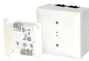
Mit dem EOL-Modul werden LSN-Stiche und LSN-Abzweigungen EN 54.13- konform abgeschlossen. Es kann Störungen der LSN-Linie und der Hilfsspannung entsprechend der EN 54-13 erkennen und meldet über die Linie einen Fehler am Bedienfeld der Brandmelderzentrale.
