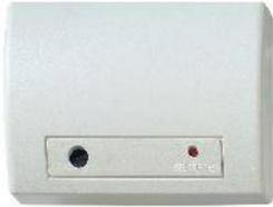
Der Funk-Glasbruchmelder dient der Überwachung von Fensterflächen ganzer Räume. Über ein Mikrofon wird das typische Geräusch beim Zerschlagen von Glasscheiben erkannt und der Glasbruch an das Funk-Gateway CM0220 gesendet. Vom Funk-Gateway wird die Information über den CM-Bus an die Zentralen CM20XX weitergeleitet.
