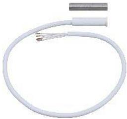
Der MK 30 ist ein Magnetkontakt zur Öffnungsüberwachung von Türen, Fenstern, Verteilern usw. Der MK 30 besteht aus einem Reedschalter in einem zylinderförmigen Kunststoffgehäuse und einem Rundstabmagneten. **(Lieferung erfolgt ohne Schrauben)**
