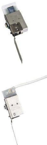
Schließblechkontakte werden für die Verschlussüberwachung von Türen eingesetzt. Die Montage erfolgt in das Schließblech des Türrahmens, wobei der Riegel des Schlosses den Schließblechkontakt betätigt.
