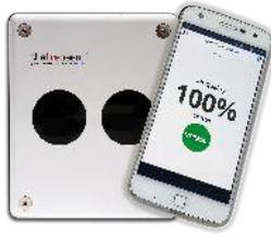
Der Firebeam ist ein Lichtschrankenrauchmelder mit Prismen-Reflektoren zur Detektion von hellem und dunklem Rauch, über eine Strecke von 7 bis 160 m, bei einer seitlichen Detektionsbreite von 7 m beiderseits der Strahlmittellachse. Bedienung über Bluetooth Applikation
