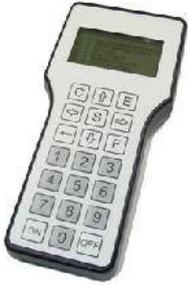
Das Handmessgerät hilft bei der Installationsvorbereitung des Funk-Gateway-System. Mit dem Handmessgerät können die Reichweiten der Funk-Komponenten sowie Funkstörungen auf den genutzten Frequenzbändern ermittelt werden.
