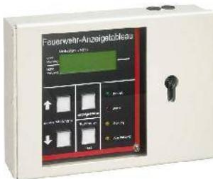
Das Feuerwehr-Anzeigetableau FAT 4000 gemäß DIN14662 ist eine Zusatzeinrichtung zum Anschluss an die Brandmeldezentrale. Es dient der Anzeige bestimmter Betriebszustände (Alarm, Störung, Abschaltung) der BMA als Sammelmeldung mittels LED, sowie als Klartext auf einem alphanumerischen Display.
