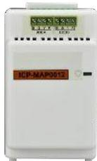
Das CAN-Splitter Modul ist ein Erweiterungsmodul für die MAP 5000. Es stellt zwei unabhängige und isolierte Stiche bereit, um weitere Bedienteile, LSN-Gateways und externe Spannungsversorgungen anzuschließen. Dies ermöglicht eine flexible Verdrahtung in verschiedene Richtungen mit einer Kabellänge von bis zu 500 m und bietet eine höhere Zuverlässigkeit.
