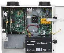
IP Basisbaugruppe TLV 1 im Gehäuse G4+ mit Netzteil
