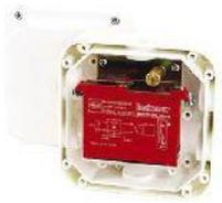
Die Sicherheitsbarriere SB3 begrenzt die elektrische Energie zwischen nicht eigensicheren und eigensicheren Stromkreisen und verhindert damit die Entzündung von Gasgemischen durch elektrische Funken.
