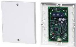
Die SE 60 LSNi ist eine Auswerteeinheit für die SmartKey Scharfschalteneinrichtung zur Steuerung einer Zugangstür ohne Eingabeeinheit (nur Sperrelement und Kontakte). SmartKey ist ein intelligentes berührungsloses System zur Schärfung der LSN-Einbruchmeldezentrale MAP 5000 LSNi. Das SmartKey System besteht aus der Auswerteeinheit, einer Eingabeeinheit, einem Sperrelement und den Schlüsseln.
