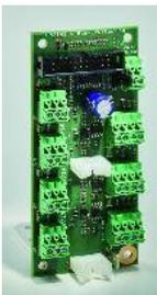
Das CM-Bus / P-Bus Erweiterungsmodul Standard CM2142 ermöglicht die Erweiterung der CM-Zentralen um die Scharfschalteneinrichtungen BC710, BC740 und BC750, als auch die Bewegungsmelder IMD 250 Bus, IMD 250 AM Bus und DMD 250 AM Bus.
