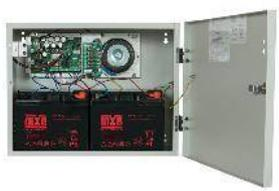
Das FPP-3000 externe Netzteil dient zur universellen Spannungsversorgung und bietet Platz für zwei Batterien mit 12V/40 Ah.
