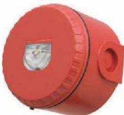
Die LX-Blitzleuchten sind Signalgeber zur optischen Alarmierung. Das Gerät verfügt über eine einzigartige Linsenbauform, mit der die benötigte Lichtintensität gemäß EN54-23 erreicht wird. Die Blitzfrequenz sowie ein reduzierter Signalisierungsbereich können über einen DIP-Schalter eingestellt werden. Die Blitzleuchte für die Deckenmontage verteilt das Licht in zylindrischer Form, die Blitzleuchte für die Wandmontage in kubischer Form.
