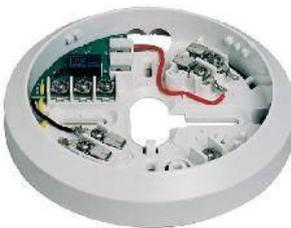
Der MSR 320 ist ein Meldersockel mit integriertem Relais für die Aufnahme und den Anschluss der automatischen Brandmelder der Serien 425 und 320. Mit diesem Sockel können die Brandmelder der Serie 320 an konventionelle Einbruchmelderanlagen angeschaltet werden.
