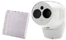
Der FRAY-ONE ist ein einfach zu montierender und kostengünstiger linearer Rauchmelder. Er deckt Entfernungen zwischen 5 m und 120 m ab. Ein reflektierendes Prisma ermöglicht die genaue Erkennung von Rauchpartikeln innerhalb der angegebenen Entfernungsreichweite. Für Reichweiten zwischen 5 m und 50 m ist ein Prisma ausreichend. Für Reichweiten zwischen 50 m und 120 m sind vier Prismen erforderlich.
