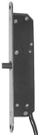
Der Typ 8320 ist ein motorisch betriebenes Sperrelement zur Anschaltung an Einbruchmeldezentralen. Es verriegelt den Zugang zum scharfgeschalteten Bereich einer Einbruchmeldeanlage (Zwangsläufigkeit). Die Sperrelemente vom Typ 8320.0 und .8320.2 haben einen integrierten Magnetkontakt zur Öffnungsüberwachung der Tür. Die Sperrelemente vom Typ 8320.2 und 8320.3 sind für den Batteriebetrieb mit sehr geringer Stromaufnahme.
