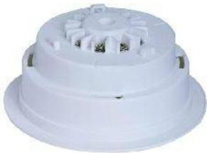
Meldersockel für Grenzwert Brandmelder der Serie 500 GLT. Der Meldersockel verfügt über Schraubklemmen für die Anschaltung des Melders an die Brandmeldezentrale. Der Meldersockel besitzt ein Alarmrelais sowie ein Störungsrelais.
