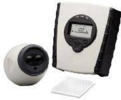
Der lineare Rauchmelder Fireray5000-EN deckt Überwachungsbereiche zwischen 8 m und 100 m ab. Ein Reflexionsprisma ermöglicht die genaue Detektion von Rauchpartikeln innerhalb des spezifizierten Entfernungsbereichs.
