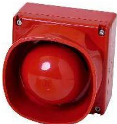
Die Sirene der Serie FNM-420U-B ist ein unterbrechungsfreier, akustischer Signalgeber in LSNi-Technologie. Die Geräte sind mit einem industriellen hochperformanten Energieträger zur Stromüberbrückung ausgestattet. Dies gewährleistet eine unterbrechungsfreie Alarmierung nach VdS 3536 selbst dann, wenn eine Stickleitung unterbrochen oder das Bussystem dauerhaft zerstört ist. Der Signalgeber in rotem Kunststoffgehäuse ist für den Einsatz im Außenbereich vorgesehen.
