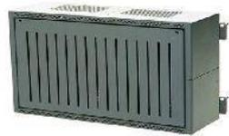
Das EEF 0002 dient zur Erweiterung der Energieversorgung der Anlagen FSO 3000/4000. In dem Energieversorgungsgehäuse befindet sich ein Netzteil UPS 2416 und die Aufnahmemöglichkeit für **zwei Notstromakkus 12 V / 45 Ah**. Der modulare Aufbau ermöglicht eine problemlose Erweiterung.
