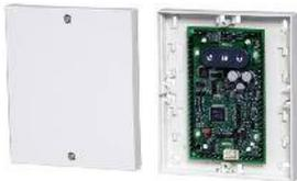
Die SE 320 LSNi ist eine Auswerteeinheit für die SmartKey Scharfschalteneinrichtung zur Steuerung einer Zugangstür mit Codetastatur-Eingabeeinheit. SmartKey ist ein intelligentes berührungsloses System zur Schärfung der LSN-Einbruchmeldezentrale MAP 5000 LSNi. Das SmartKey System besteht aus der Auswerteeinheit, einer Eingabeeinheit, einem Sperrelement und den Schlüsseln.
