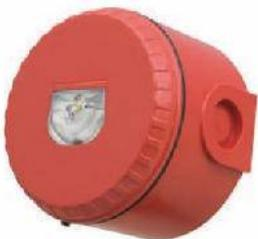
Die LX-Blitzleuchten sind Signalgeber zur optischen Alarmierung. Das Gerät verfügt über eine einzigartige Linsenbauform, mit der die benötigte Lichtintensität gemäß EN54-23 erreicht wird. Die Blitzfrequenz sowie ein reduzierter Signalisierungsbereich können über einen DIP-Schalter eingestellt werden. Die Blitzleuchte für die Deckenmontage verteilt das Licht in zylindrischer Form, die Blitzleuchte für die Wandmontage in kubischer Form.
