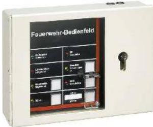
Das Feuerwehr-Bedienfeld ist eine genormte Zusatzeinrichtung für Brandmeldeanlagen, die über eine Übertragungseinrichtung zur Feuerwehr verfügen (entsprechend DIN 14661). Das FBF 100 LSN ist ein Feuerwehr-Bedienfeld zum direkten Anschluss an den LSN-Bus der Brandmeldezentrale.
