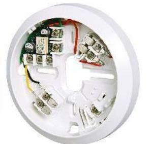
Der MSR 420 ist ein Meldersockel mit integriertem Relais für die Aufnahme und den Anschluss der automatischen Brandmelder der Serie 425. Mit diesem Sockel können die Brandmelder der Serie 425 an dem neuen LSNi Bus der Brandmeldezentrale FSO 3000/4000 angeschaltet werden.
