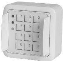
An der Codetastatur mit integrierter Eingabeeinheit TEE wird mit Hilfe des elektronischen SmartKey-Schlüssels und einer Zahlenkombination scharf- bzw. unscharf geschaltet. Drei LED und ein Summer informieren dabei über den Zustand des Systems sowie der Bedienung. Die Eingabeeinheit kann sowohl auf Putz als auch unter Putz montiert werden (außerhalb des gesicherten Bereiches).
