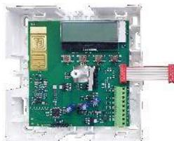
Zur Erweiterung der CM-Bus Einbruchmeldezentralen CM UNITED um Funk-Komponenten. Mit dem Funk-Gateway, das an den CM-Bus angeschlossen wird, kann die Bus-Zentrale um jeweils bis zu 32 Funkkomponenten erweitert werden. Es können mehrere Funk-Gateway CM0220 angeschlossen werden. Die Parametrierung erfolgt direkt am Funk-Gateway.
