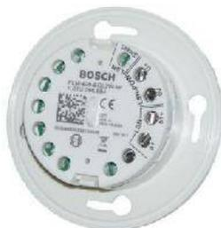
Mit dem EOL-Modul werden LSN-Stiche und LSN-Abzweigungen EN 54.13- konform abgeschlossen. Es kann Störungen der LSN-Linie entsprechend der EN 54-13 erkennen und meldet über die Linie einen Fehler am Bedienfeld der Brandmeldezentrale.
