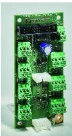
Das CM-Bus / P-Bus Erweiterungsmodul Standard CM2142 ermöglicht die Erweiterung der CM-Zentralen um die Scharfschalteneinrichtungen BC710, BC740 und BC750, als auch die Bewegungsmelder IMD 250 Bus, IMD 250 AM Bus und DMD 250 AM Bus.
