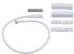
Der MK 30 ist ein Magnetkontakt zur Öffnungsüberwachung von Türen, Fenstern, Verteilern usw. Der MK 30 besteht aus einem Reedschalter in einem zylinderförmigen Kunststoffgehäuse und einem Rundstabmagneten. Zur Aufbau-Montage liegen diesem Set 2 Aufbaugehäuse und je 2 Distanzblöcke 2,5 mm und 5 mm bei. **(Lieferung erfolgt ohne Schrauben)**
