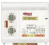
Das DE Schnittstellenmodul stellt die Schnittstellen für die überwachte Anschaltung von Signalgebern, für ein Übertragungsgerät und einen Drucker zur Verfügung.
