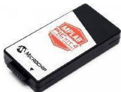
MPLAB PIC-KIT-4 mit Programmer-to-Go Funktionalität für 8-Bit, 16-Bit und 32-Bit PIC MCUs und dsPICs und auch SAM MCU-Bausteine
