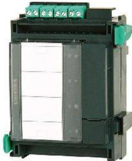
Funktionsmodul zur Anschaltung eines LSN-Ringes mit bis zu 254 LSNI-Elementen oder 127 LSN classic-Elementen, bei einem maximalen Linienstrom von 300 mA.
