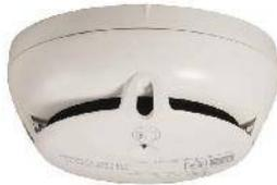
Der OOH740-A9-Ex ist ein dual-optischer Melder zur Detektion von Bränden in explosionsgefährdeten Bereichen der Zone 0, 1 und 2. Er kann durch das Einsetzen definierter Widerstände entweder als dual- optischer oder thermischer Melder programmiert werden.
