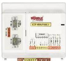
Das Alarmmodul stellt die Schnittstellen für die überwachte Anschaltung von Signalgebern, für ein Übertragungsgerät und einen Drucker zur Verfügung.
