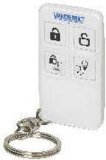
Die WRMT ist eine multifunktionale Fernsteuerung für die Kommunikation des Benutzers mit seinem SPC-System. Das Gerät unterstützt die üblichen Funktionen wie „Scharf“, „Unscharf“ und „Intern scharf“ sowie eine vom Benutzer programmierbare Ausgangsfunktion und eine SOS-Panikfunktion. Die Batterie der WRMT ist austauschbar und die Fernsteuerung somit extrem langlebig
