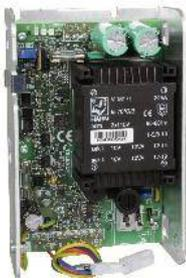
Das NT 7500 ist ein Netzteil zum Einbau in das Gehäuse S8 und dient der Energieversorgung der Übertragungsgeräte comXline (auch mit GSM-Funk Ersatzweg).
