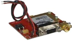
Das ITS-MAP0008 GPRS-Modul dient dazu, einen Funkdaten-Übertragungsweg in Kombination mit der MAP 5000 COM und dem IP-Übertragungsgerät zu erstellen. Das GMS-Modul ermöglicht eine Funkübertragung von Ereignissen über GPRS an eine Leitstelle.
