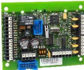
Das Türmodul comlock 410 UFM dient zum Anschluss der gesamten Peripherie einer Zugangstür an das universelle Funkmodul UFM 260. Für die Montage bietet das UFM 260 einen Einbauplatz.
