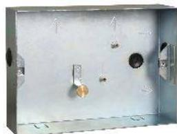
Das Unterputzgehäuse für Einputzmontage UG 801 EP dient zur uP Montage des BT 801. Das UG 801 EP ist mit einer Rändelschraube für die Feineinstellung des Sabotagekontaktes ausgestattet. Durch einen bis zu  $\pm 2,5^\circ$  drehbaren Montagerahmen lässt sich ein nicht lotgerechter Einbau des Unterputzgehäuses ausgleichen.
