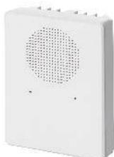
Das SPC V340 /341/440 Audiomodul erweitert die SPC Systeme über den X-BUS mit Audioverifikationszonen. Zudem verfügt es über 4 verdrahtete Eingänge und 1 Ausgang. Das eingebaute Mikrophon und der eingebaute Lautsprecher ermöglichen die Aufzeichnung der Raumakustik vor und nach dem Alarmereignis und die Live Audioalarmverifikation (hören/sprechen) durch den Wachdienst mit dem SPC System. Bis zu 3 Audio Nebenstellen (SPCV310/410) können an der Erweiterung angeschlossen werden.
