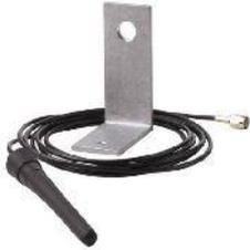
Mit dem Aussenantennen-Kit SPC W101 (868 MHz) kann ein in einen Schrank eingebautes GSM-Modul oder Funkmodul mit einer extern installierten Antenne verbunden werden, um einen optimalen Empfang zu erzielen. Zum Kit gehören eine Stummelantenne, 2 m Kabel mit Steckern sowie ein Befestigungswinkel. Die Antenne wird über den SMA-Anschluss an das GSM-Modul oder an das Funkmodul angeschlossen.
