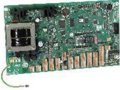
Die comslave 400-FK ist eine Erweiterungsplatine die zur abgesetzten Montage in ein GR80 oder GR100 Leergehäuse eingebaut wird. Die comslave 400-FK besitzt ein integriertes Netzteil für max. 26 Ah. Die Platine erweitert die EMZ um zwei unabhängige Bereiche mit den zugehörigen Ein-/Ausgängen und Schnittstellen.
