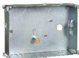
Das Unterputzgehäuse für Hohlwandmontage UG 801 HW dient zur uP Montage des BT 801 in Hohlwänden. Das UG 801 HW ist mit einer Rändelschraube für die Feineinstellung des Sabotagekontaktes ausgestattet. Durch einen bis zu  $\pm 2,5^\circ$  drehbaren Montagerahmen lässt sich ein nicht lotgerechter Einbau des Unterputzgehäuses ausgleichen.
