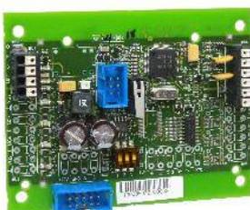
Das Signalgebermodul comlock 400 UFM dient zum Anschluss eines optisch-/akustischen Signalgebers an das universelle Funkmodul UFM 260. Für die Montage bietet das UFM 260 einen Einbauplatz.
