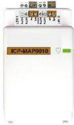
Das LSN-Modul ist ein Erweiterungsmodul für die MAP 5000 LSNi. Es stellt die Anschlüsse zum Betrieb eines LSN-Ringes oder zweier LSN-Stiche in LSNi-Technologie (LSN Improved) mit einem maximalen Ausgangsstrom von 300 mA zur Verfügung. Das LSN-Modul unterstützt bis zu 127 LSN-Komponenten. Es wird auf dem Schwenkrahmen des Zentralengehäuses montiert und an den internen CAN-Bus der Zentrale angeschlossen.
