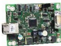
Das Interface KNX 400 IP dient der bidirektionalen Umwandlung von Protokoll Daten der GMS-Schnittstelle der EMZ complex 400H-FK auf KNX.
