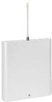
Der Empfänger FST-E 210 ist eine Komponente der Funksteuereinheit und ist für die Verbindung von FST-Handsendern an ein Auswerte- und Steuergerät mit comlock-Schnittstelle (z.B. complex 200/400H-FK, comlock 1030, comlock 3000) vorgesehen.
