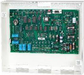
Die ISE plus ist die Auswerteeinheit der ISE-Scharfschaltanlage. ISE ist eine intelligente Systemlösung in konventioneller Technik zur Scharfschaltung von Einbruchmeldeanlagen sowie zur Ansteuerung von Türöffnern, Schranken, Toren usw. in Zutrittskontrollsystemen. Zum System gehören einzelne Komponenten (z.B. HF-Leser, Schlüssel), die abhängig von den geforderten Einsatzbedingungen individuell zusammengestellt werden.
