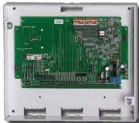
Auswerte- und Steuergerät zum Scharf-/ Unscharfschalten von Einbruchmeldeanlagen, sowie zur Zutrittskontrolle an einer Tür über Ansteuerung von elektrisch ansprechbaren Elementen (wie Türöffner, Motorschloss, Zylinder etc.). Mehr-Türen-Lösung zur beliebigen Bedienung des Systems von mehreren Eingängen aus. Anschließbar an alle gängigen Einbruchmelderzentralen. Zum Anschluss von maximal zwei Leseinheiten.
