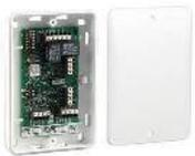
Das Universalmodul BUS-1 UMB 122 dient zum Anschluss von zwei konventionellen Meldergruppen an den BUS-1. Ausgangsseitig können zwei potentialfreie Relais zum Schalten von Lasten an Niederspannung angesteuert werden. Das Universalmodul 122 UMB steht in den 2 Varianten Aufputz und Unterputz zur Verfügung.
