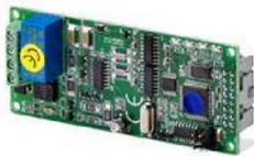
Das SPC N110 analoge Wählgerät bietet die Möglichkeit die SPC Zentrale um die Funktionen Alarm- und SMS- Übertragung über das analoge Telefonnetz zu erweitern.
