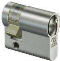
Profil-Halbzylinder mit erhöhtem Schutz gegen unberechtigtes Öffnen und gewaltsame Aufbruchversuche. Der Zylinder mit drei Schlüsseln hat eine Länge von 30 mm und kann in verlängerter Ausführung von jeweils 5 mm bestellt werden.
