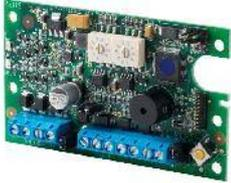
Das SPC G310 ermöglicht die Kommunikation zwischen dem SPC-Controller und E-BUS Peripheriegeräten.
