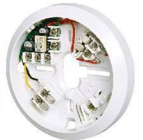
Der MSR 420 ist ein Meldersockel mit integriertem Relais für die Aufnahme und den Anschluss der automatischen Brandmelder der Serie 425. Mit diesem Sockel können die Brandmelder der Serie 425 an dem neuen LSNi Bus der Brandmelderzentrale FSO 3000/4000 angeschaltet werden.
