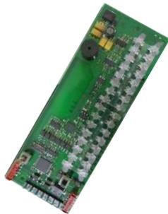
Der Bausatz ATG 420 LSNi ist eine Platine mit 32 mehrfarbigen LED (rot/gelb) und wird in das Gehäuse BAT 100 LSN eingebaut.
