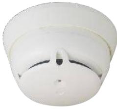
Der batteriebetriebene Funk-Brandmelder verfügt über eine hochwertige opto-elektronische Messkammer mit zwei optischen Sendern, einen optischen Empfänger und zwei Temperatursensoren.
