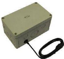
Der ADP4000 dient gemäß DIN 14662 zur redundanten Anschaltung des FAT4000. Für den Einsatz als Redundanz-Adapter außerhalb der BMZ wird dringend empfohlen, die Gehäuse unmittelbar aneinander zu montieren, um eine Beschädigung der Anschlussleitung zu verhindern.
