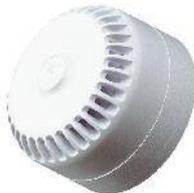
Die Sirenen der Serie 320 sind akustische Signalgeber in GLT-Technik mit elektronischem Tongenerator für 32 verschiedene Tonvarianten und stufenlos einstellbarer Lautstärke zur Anschaltung an Brandmelder- oder Hausalarmzentralen.
