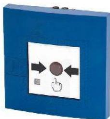
Druckknopfmelder dienen zur manuellen Auslösung eines Brandalarms. Die Druckknopfmelder der Serie FMC-120 werden in der Grenzwertechnik (GLT) eingesetzt. Für den Einsatz an einer Funkzentrale ist das Funk-Input-Modul SGM1200 erforderlich.
