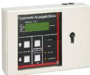
Das Feuerwehr-Anzeigetableau FAT 2002 gemäß DIN14662 ist eine Zusatzeinrichtung zum Anschluss an die Brandmeldezentrale. Es dient der Anzeige bestimmter Betriebszustände (Alarm, Störung, Abschaltung) der BMA als Sammelmeldung mittels LED, sowie als Klartext auf einem alphanumerischen Display.
