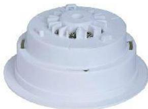
Meldersockel für Grenzwert Brandmelder der Serie 500 GLT. Der Meldersockel FCA-500-E EU wird an letzter Position einer Stichleitung eingesetzt und mit einem EOL Widerstand versehen.
