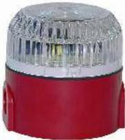
Die Blitzleuchten der Serie 320 sind universell einsetzbare Signalgeber für die optische Alarmierung zur Anschaltung an Brandmelder- oder Hausalarmzentralen. Im transparenten Signalgeber-Oberteil befindet sich die Blitzröhre. Diese sendet bei Ansteuerung durch die Zentrale, entsprechend der Farbe des Signalgebers, im Sekundentakt rote, weiße, gelbe oder grüne Lichtblitze aus.
