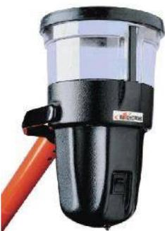
Das SOLO 461 Prüfgerät für thermische Melder wird benutzt um thermische Melder vor Ort zu testen. Das Gerät arbeitet mit Hilfe einer Batterie und leitet erhitzte Luft zum Sensor des Melders. Die Lieferung erfolgt ohne Teleskopstange.
