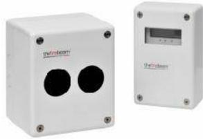
Der Firebeam ist ein Lichtschrankenrauchmelder mit Prismen-Reflektoren zur Detektion von hellem und dunklem Rauch, über eine Strecke von 7 bis 160 m, bei einer seitlichen Detektionsbreite von 7 m beiderseits der Strahlmittellachse.
