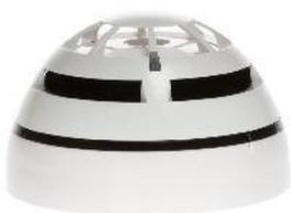
Funk-Vernetzbarer Hitze-/Wärmemelder mit Zulassung EN 54-5, wie auch nach EN 54-25 (Funk). Der batteriebetriebene Funk-Melder ist geeignet für den Einbau in Brandmeldeanlagen mit dem Funk-Erweiterungsmodul SGCWE. Der Melder reagiert auf einen schnellen Temperaturanstieg sowie eine Maximaltemperatur von 58 °C oder eine Maximaltemperatur von 78 °C.
