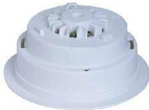
Meldersockel für LSN-Bus Brandmelder der Serie 520 LSN. Der Meldersockel verfügt über Schraubklemmen für die Anschaltung des Melders an die Brandmelderzentrale. Mit den Klemmen verbundene Kontakte garantieren eine sichere elektrische Verbindung bei der Montage des Meldereinsatzes.
