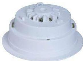
Meldersockel für Grenzwert Brandmelder der Serie 500 GLT. Der Meldersockel verfügt über Schraubklemmen für die Anschaltung des Melders an die Brandmelderzentrale. Der Meldersockel besitzt ein Alarmrelais sowie ein Störungsrelais.
