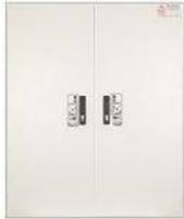
Geprüftes Brandschutzgehäuse mit einer Feuerwiderstandsdauer von mindestens 30 Minuten, bei einer Brandbelastung von außen und innen im Sinne F30 und I30 geprüft in Anlehnung an DIN 4102 bzw. DIN EN 1634-3. Einhaltung der Grenzwerte der EN 1047-2 oder EN12101-10 im Normalbetrieb und im Brandfall möglich.
