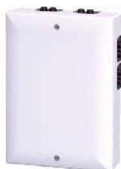
Der Octo-Eingangskoppler FLM-420-I8R1-S verfügt über acht widerstandsüberwachte Eingänge, bei denen zwei verschiedene Überwachungsfunktionen eingestellt werden können. Zusätzlich verfügt er über ein Wechselkontakt-Relais zur Bereitstellung eines potentialfreien Ausgangskontaktes.
