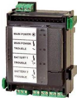
Das Funktionsmodul überwacht die Spannungsversorgung der gesamten Zentrale und regelt temperatur- und zeitgesteuert das Laden von bis zu vier Akkus.
