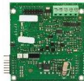
Die IRIS Loop SS ist eine Ring-Erweiterungskarte für die Zentrale IRIS zur Anschaltung von bis zu 198 Funk-Komponenten.
