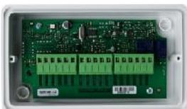
SensorIS MIO04 ist ein adressierbares Modul mit 4 Relaisausgängen. Das Modul ist für den Einsatz in adressierbaren Brandmeldeanlagen konzipiert und unterstützt das Kommunikationsprotokoll TTE. Der SensorIS MIO04 wird über die Brandmeldezentrale adressiert und kann über das Kommunikationsprotokoll gesteuert werden. Das Modul ist in einer separaten kleinen, für die Wandmontage geeigneten Kunststoffbox mit transparenter Abdeckung zur Sichtkontrolle montiert.
