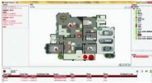
Observer ist eine Softwareanwendung zur Überwachung von Standorten, die mit Teletek adressierbaren Brandmeldeanlagen IRIS ausgestattet sind.
