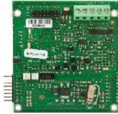
Die IRIS Loop TTE ist eine Ring-Erweiterungskarte für die Zentrale IRIS zur Anschaltung von drahtgebundenen SensoIRIS-Komponenten.
