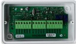
SensoIRIS MIO40 ist ein adressierbares Modul mit 4 Eingängen zur Überwachung von Analogsignalen. Das Modul ist für den Einsatz in adressierbaren Brandmeldeanlagen konzipiert und unterstützt das Kommunikationsprotokoll TTE. Der SensoIRIS MIO40 wird über die Brandmeldezentrale adressiert und kann über das Kommunikationsprotokoll gesteuert werden. Das Modul ist in einer separaten kleinen, für die Wandmontage geeigneten Kunststoffbox mit transparenter Abdeckung zur Sichtkontrolle montiert.
