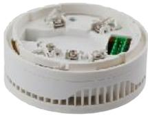
SensolIRIS BSOU ist eine adressierbare Sockelsirene mit eingebautem Trennmodul, geeignet für den Einbau in adressierbare Brandmeldeanlagen mit dem TTE-Kommunikationsprotokoll. Die Sirene wird von der Zentrale aus adressiert und kann über das Kommunikationsprotokoll gesteuert werden. Die adressierbare Sockelsirene SensolIRIS BSOU IS unterstützt 32 unterschiedliche Signaltöne bei zwei Lautstärken.
