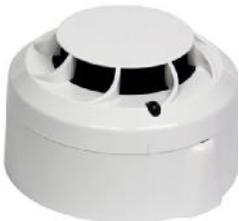
Funk-Vernetzbarer Rauchmelder mit Zulassung EN54-7, -17, wie auch nach EN 54-25 (Funk). Der batteriebetriebene Funk-Melder ist geeignet für den Einbau in adressierbare Brandmeldeanlagen mit dem Funkgateway M200G-RG. Es handelt sich um einen Optischen Rauchmelder. Der Melder wird auf dem Funkmeldersockel B501RF montiert.
