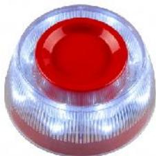
SensorIS WSST IS ist eine adressierbare Wandsirene /-Blitzleuchte mit eingebautem Trennmodul, geeignet für den Einbau in adressierbaren Brandmeldeanlagen mit dem TTE-Kommunikationsprotokoll. Der Melder wird von der Zentrale aus adressiert und kann über das Kommunikationsprotokoll gesteuert werden.
