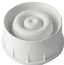
Die batteriebetriebene Funk-Sirene ist geeignet für für den Einbau in adressierbare Brandmeldeanlagen mit dem Funkgateway M200G-RG. Die Funk-Sirene beinhaltet einen drahtlosen Empfänger und wird in dem Funk-Meldersockel B501RF montiert.
