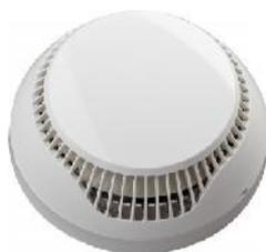
SensolRIS S130 IS ist ein adressierbarer optischer Rauchmelder mit eingebautem Isolator, geeignet für den Einbau in adressierbare Brandmeldeanlagen mit TTE-Kommunikationsprotokoll. Der Melder wird von der Zentrale aus adressiert und kann über das Kommunikationsprotokoll gesteuert werden.
