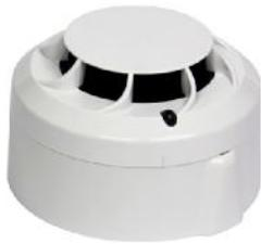
Funk-Vernetzbarer Hitze-/Wärmemelder mit Zulassung EN54-5, wie auch nach EN 54-25 (Funk). Der batteriebetriebene Funk-Melder ist geeignet für den Einbau in adressierbare Brandmeldeanlagen mit dem Funkgateway M200G-RG. Der 52051E-RF verfügt über eine festgelegte 58 °C Temperatur-Erfassung (A1S). Der Melder wird auf dem Funkmeldersockel B501RF montiert.
