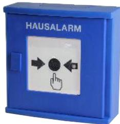
Der batteriebetriebene Funk-Druckknopfmelder ist geeignet für für den Einbau in adressierbare Brandmeldeanlagen mit dem Funkgateway M200G-RG. Er enthält einen drahtlosen Sender-Empfänger und hat eine abnehmbare Rückwand.
